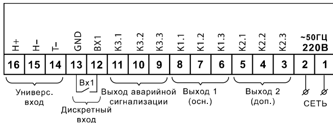
Рис. 2. Расположение контактов на задней панели прибора TP444
