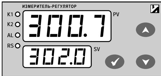
Рис. 1. Внешний вид лицевой панели прибора TP444
